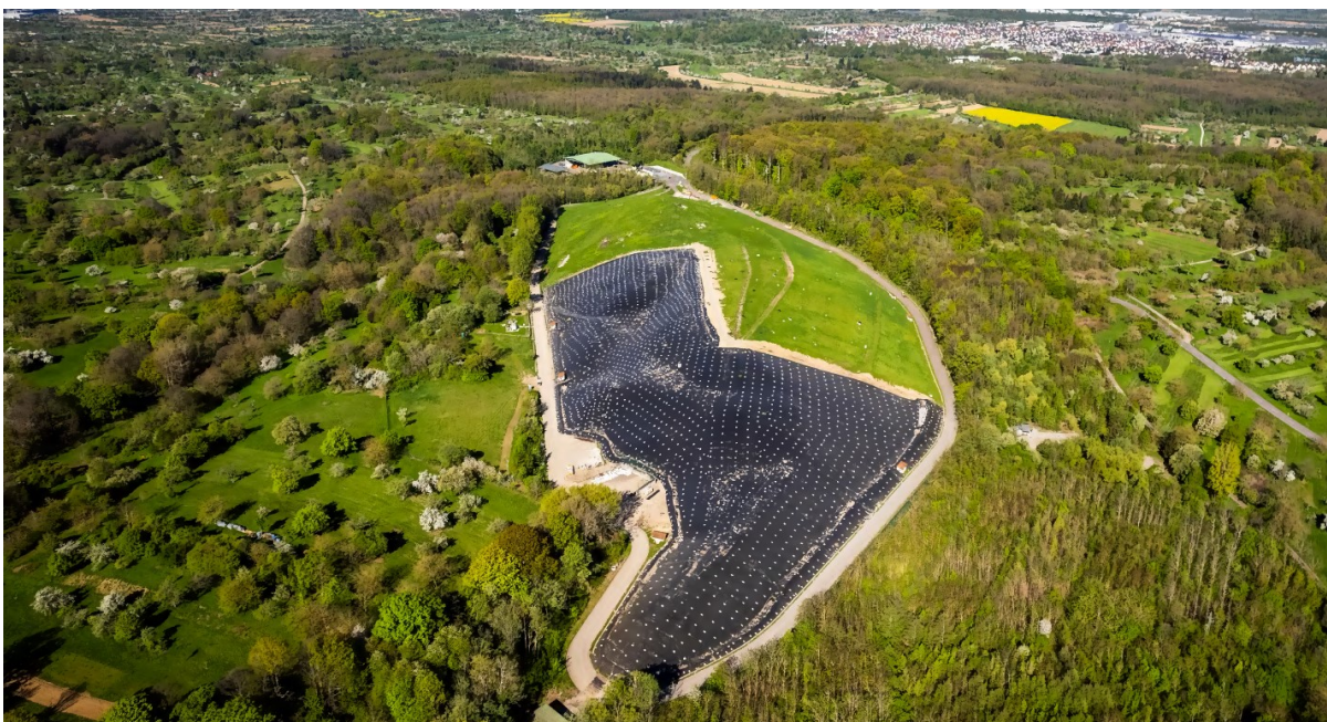
Abbildung 3: Drohnenaufnahmen der Entsorgungsanlage „Hintere Dollert“ nach Fertigstellung der Abdeckung
