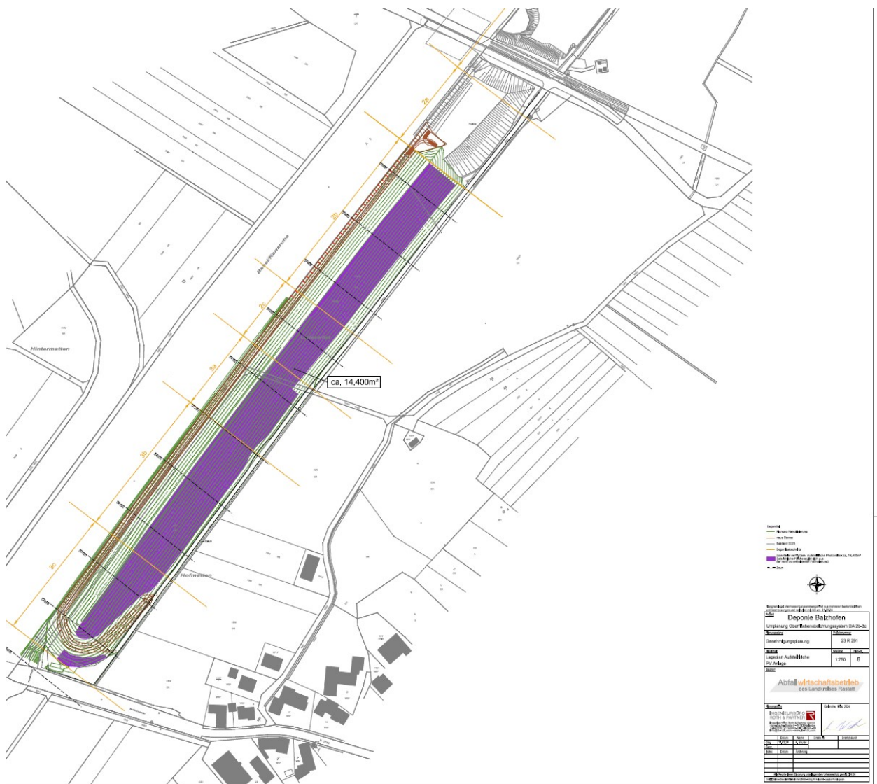
Abbildung: Lageplan einer potenziellen Aufstellfläche der PV-Anlage
