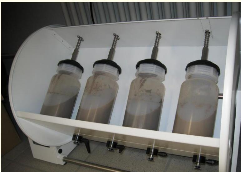
Überkopfschüttler, welcher für das Schüttelverfahren verwendet wird
