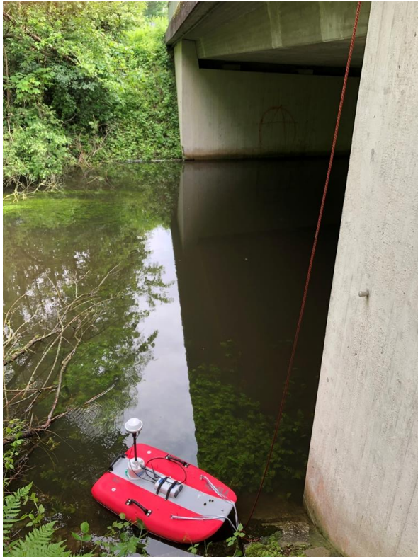
Abbildung 2.6: Schwimmfähiges, seilgeführtes ADCP-System
